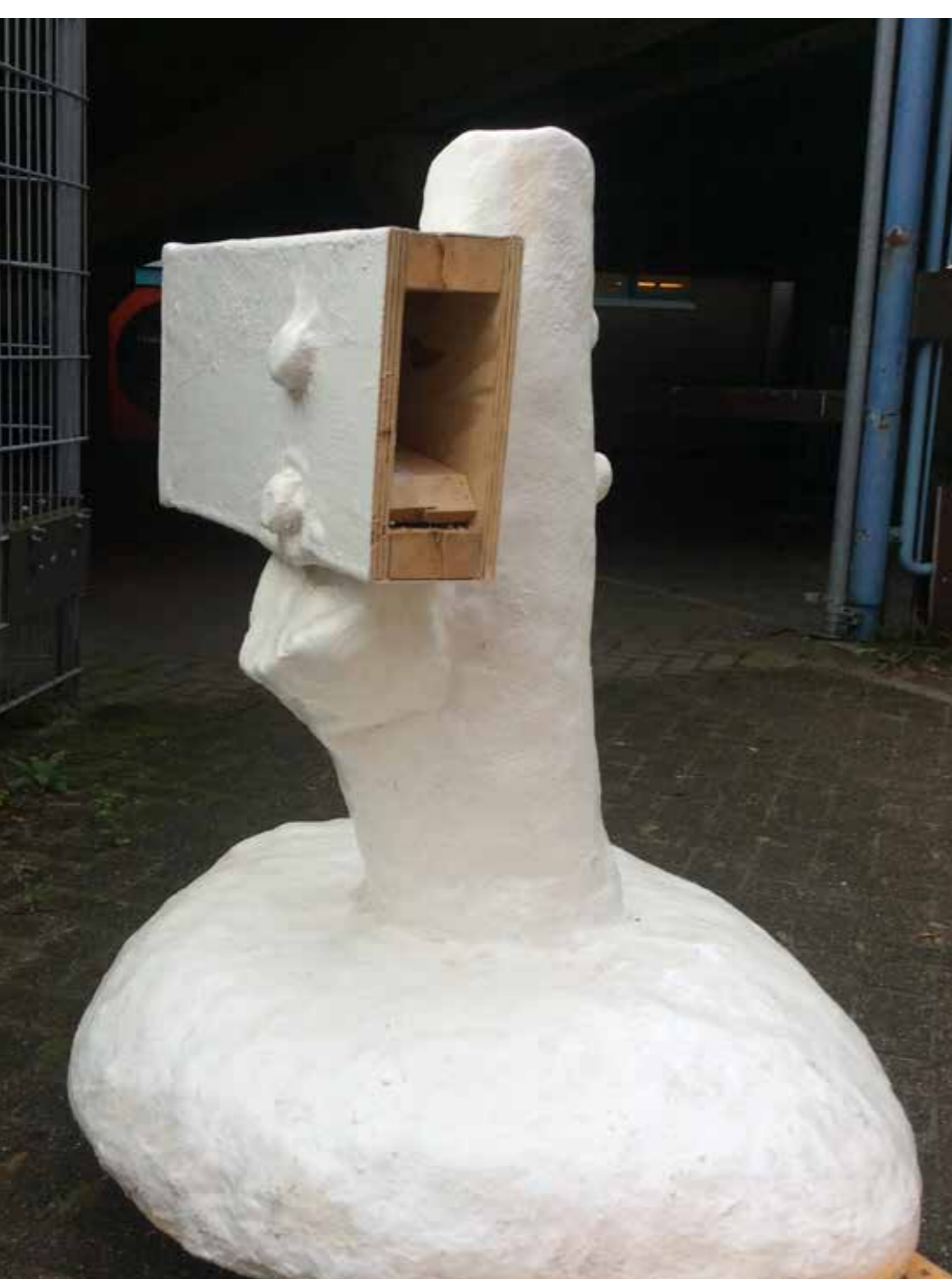
Mock-up principe detail 1:1 > Het witte "maquette" deel zal vervaardigd worden uit de benodigde bouwmaterialen hout,staal, foam, ..... die omkleed worden met een witte huid. In dit geval polyester-glasvezel.
